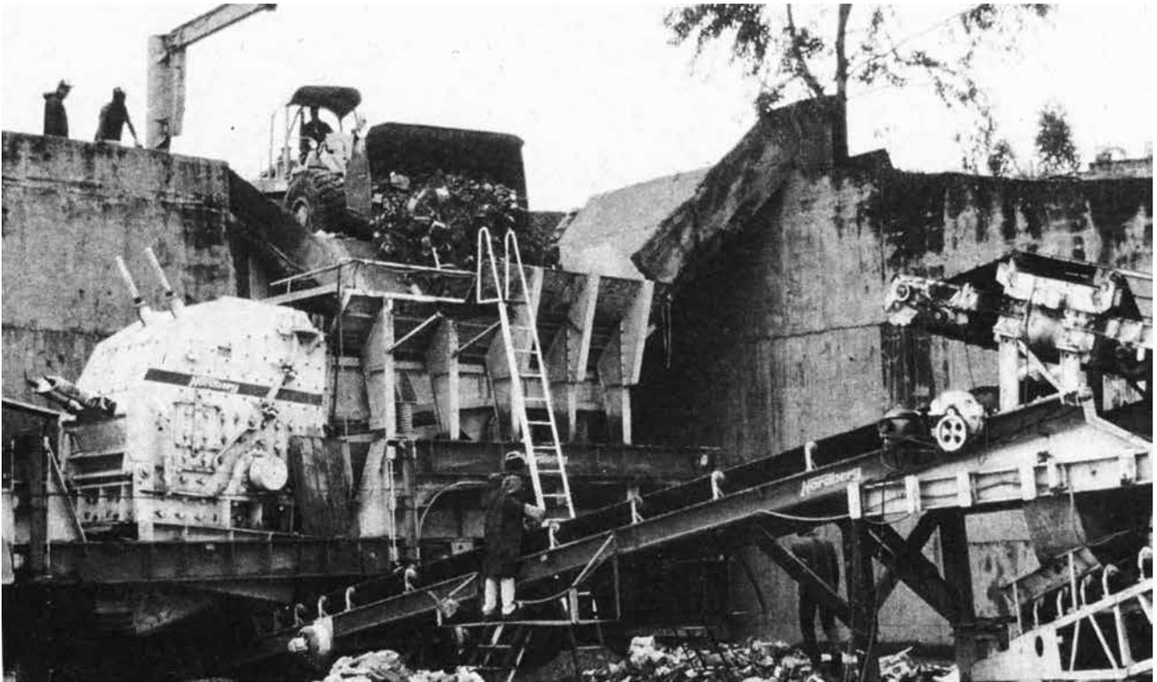
Figura 1: Lançamento de entulho reciclável em equipamento de trituração (Aterro de Itatinga-SP, atualmente esgotado)
