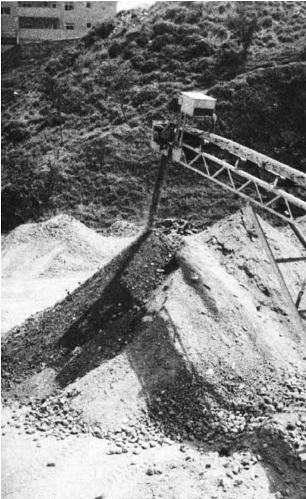
Figura 4b - Material triturado pronto para ser reutilizado (Estação de Reciclagem de Entulho do Estoril - Prefeitura de Belo Horizonte-MG)
