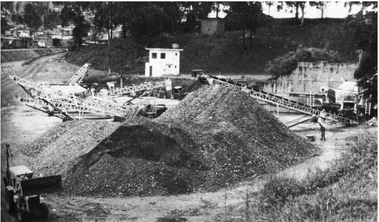
Figura 2 - Montes de agregados reciclados de entulho. Ao fundo, à direita, equipamento de trituração e correias transportadoras (Aterro de Itatinga-SP, atualmente esgotado)
