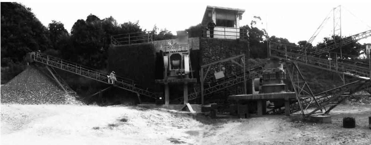
Figura 4a - Equipamento para reciclagem (trituração) de entulho (Estação de Reciclagem de Entulho - Prefeitura de Belo Horizonte-MG)
