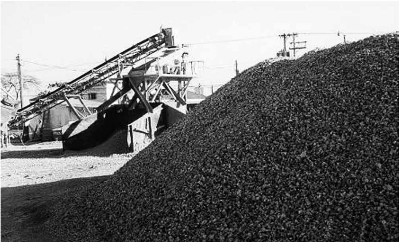
Figura 3 - Aspecto do agregado reciclado, a ser destinado para obras de pavimentação
