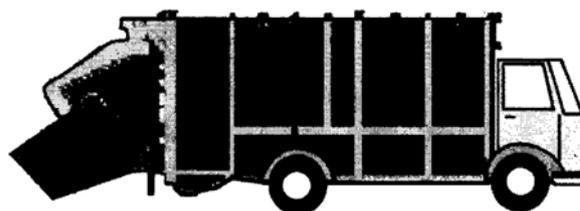
Figura 4c – Caminhão compactador com dispositivo para basculamento de recipiente estacionário
