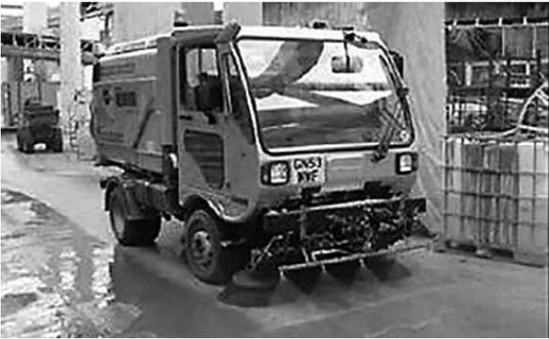
Figura 10 – Veículo para varrição mecânica
