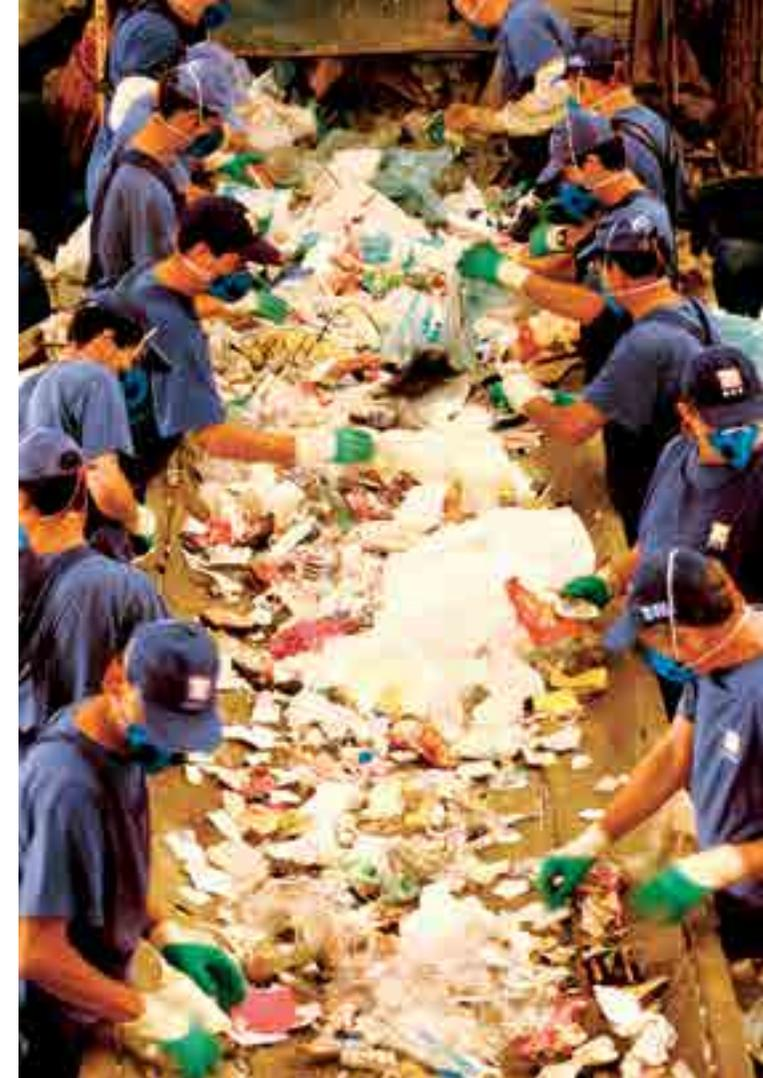
FIGURA 19 – ESTEIRA TRANSPORTADORA DE SEPARAÇÃO
